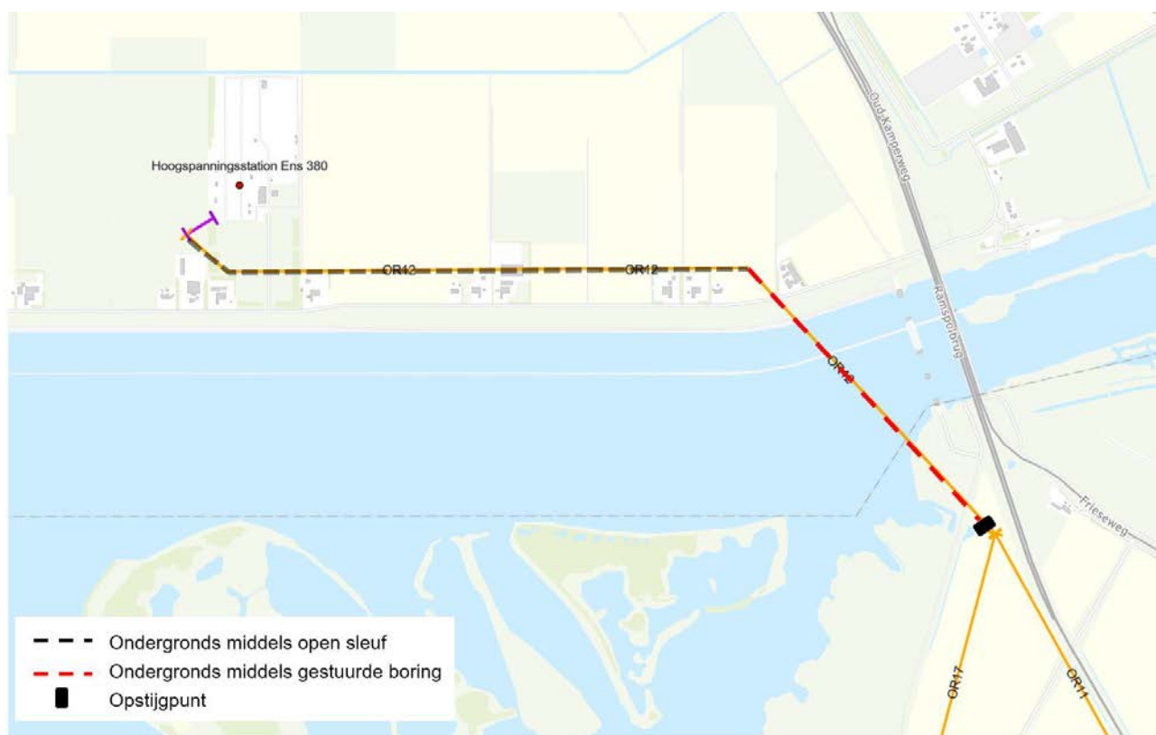
Figuur 1.9 Situatie ondergrondse aanleg bij deeltracé OR12
