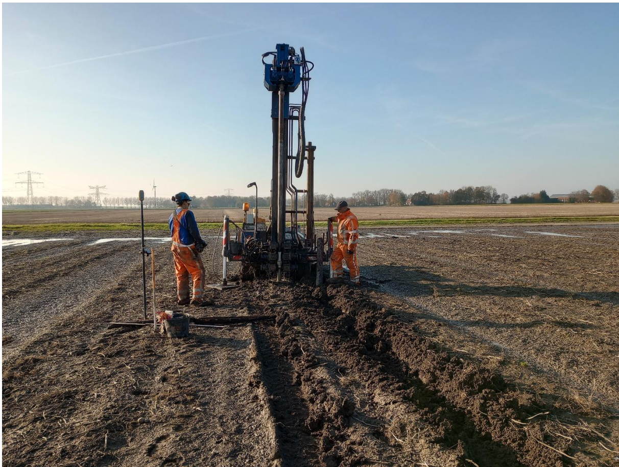
Figuur 4. Een impressie van het verkennend booronderzoek met een Aqualock 7 (foto: F. van der Wal).
