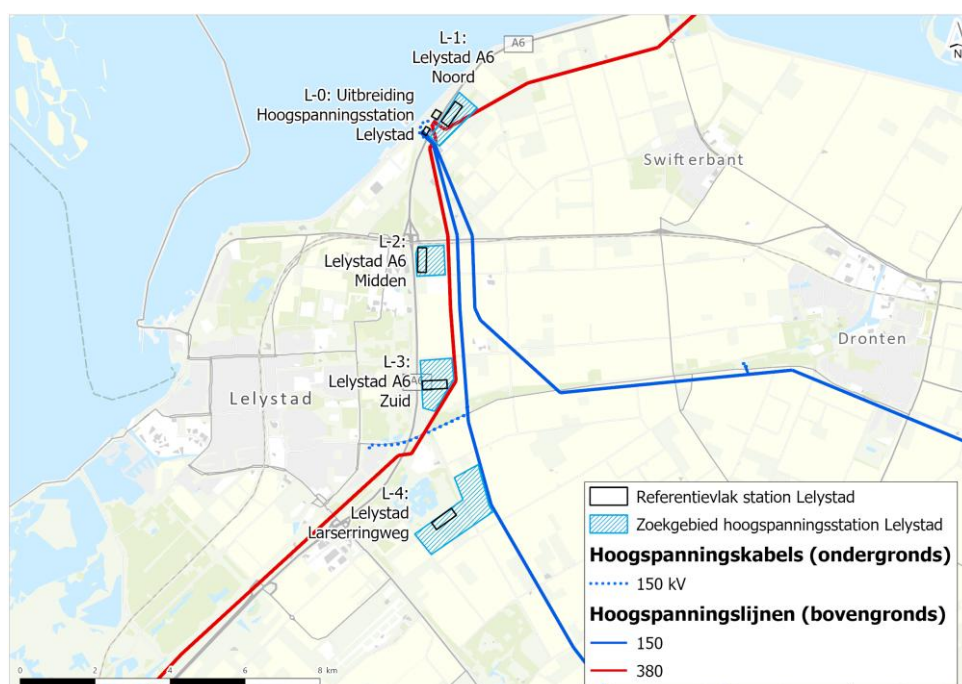
Figuur 7.1 Locatiealternatieven uitbreiding bestaand hoogspanningsstation of nieuw hoogspanningsstation Lelystad
