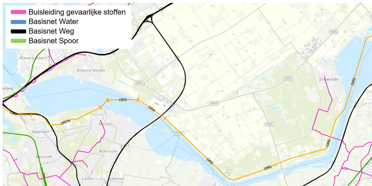
Figuur 5.8 Aanwezige buisleidingen en transportroutes, bij een gedeelte van onderzoeksalternatief Zuid-Oranje-1 (de oranje lijn met de aanduidingen van de deeltracés erin)
