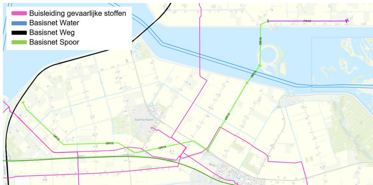
Figuur 6.4 Aanwezige buisleidingen en transportroutes gevaarlijke stoffen, in combinatie met onderzoeksalternatief Noord-Groen-1 (de lichtgroene en paarse lijn met de aanduidingen van de deeltracés erin)
