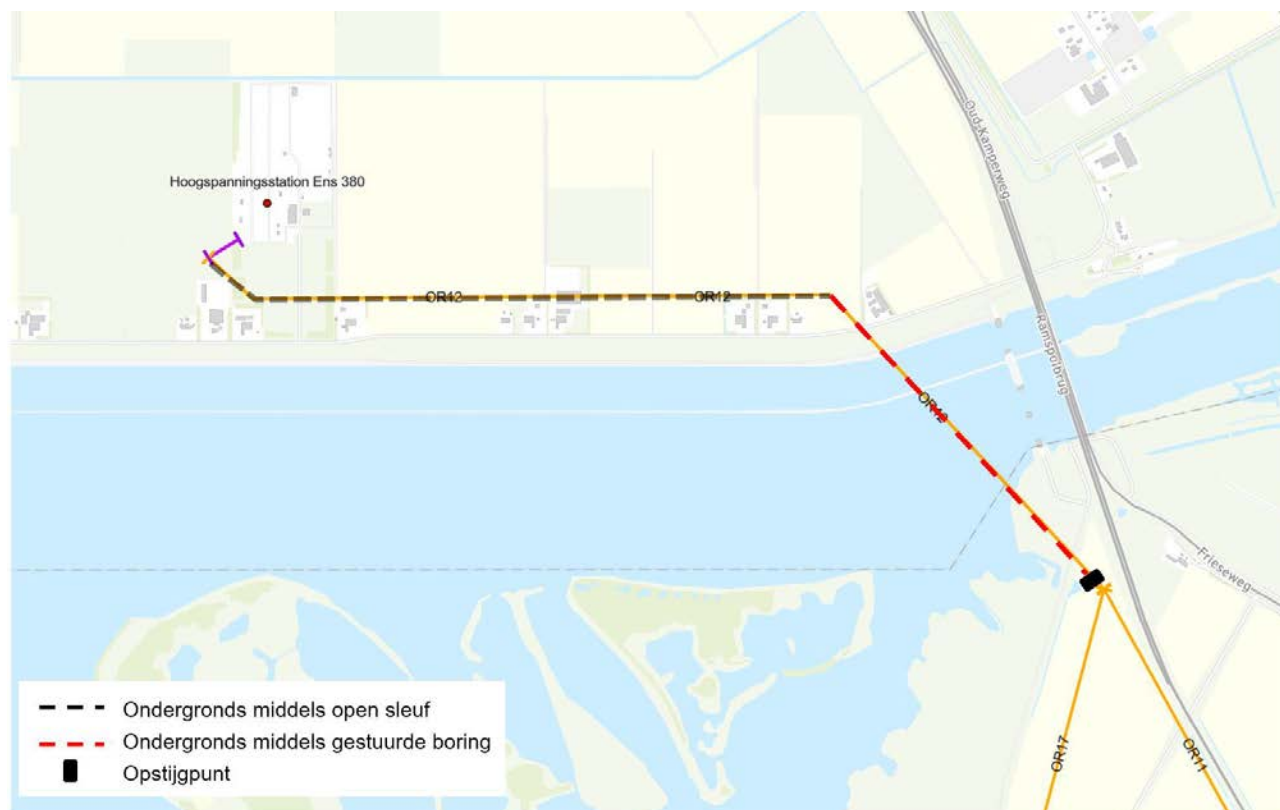
Figuur 1.9 Situatie ondergrondse aanleg bij deeltracé OR12
