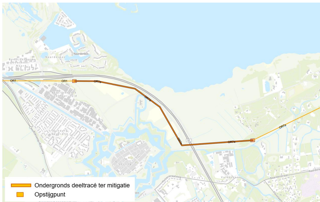
Figuur 8.12 Deeltracé OR7a gedeeltelijk ondergronds nabij Naardervesting vanwege UNESCO Werelderfgoed Hollandse Waterlinies
