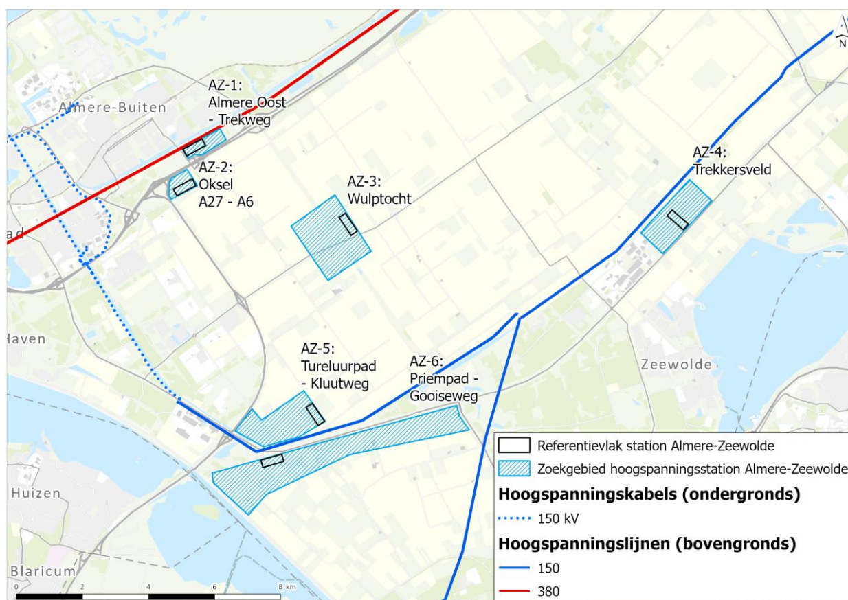
Figuur 1.14 Zoekgebieden en referentievlakken nieuw 380 kV-hoogspanningsstation Almere-Zeewolde
