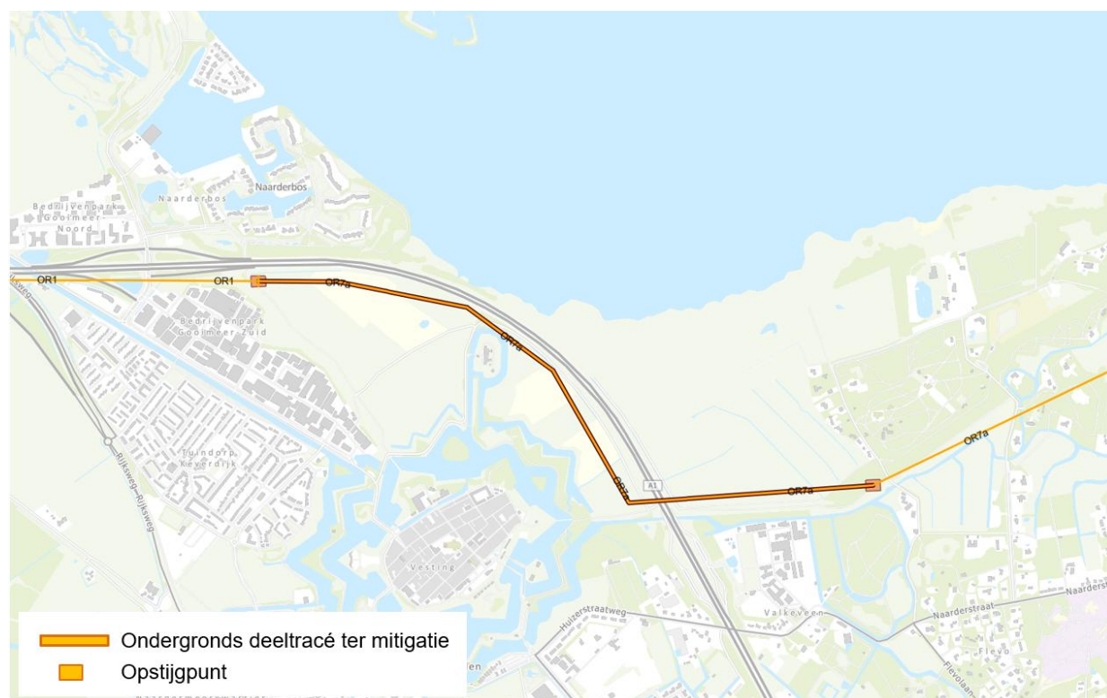
Figuur 8.5 Deeltracé OR7a gedeeltelijk ondergronds nabij Naarderving vanwege UNESCO Werelderfgoed Hollandse Waterlinies
