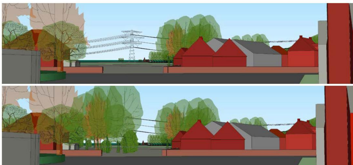
Figuur 8.4 Een hoogspanningsverbinding die zichtbaar is vanuit een fictieve dorpskern (boven), kan vanuit het dorp minder zichtbaar worden gemaakt door op strategische plekken beplanting aan te brengen (bron: landschap en hoogspanningsnet, 2017)
