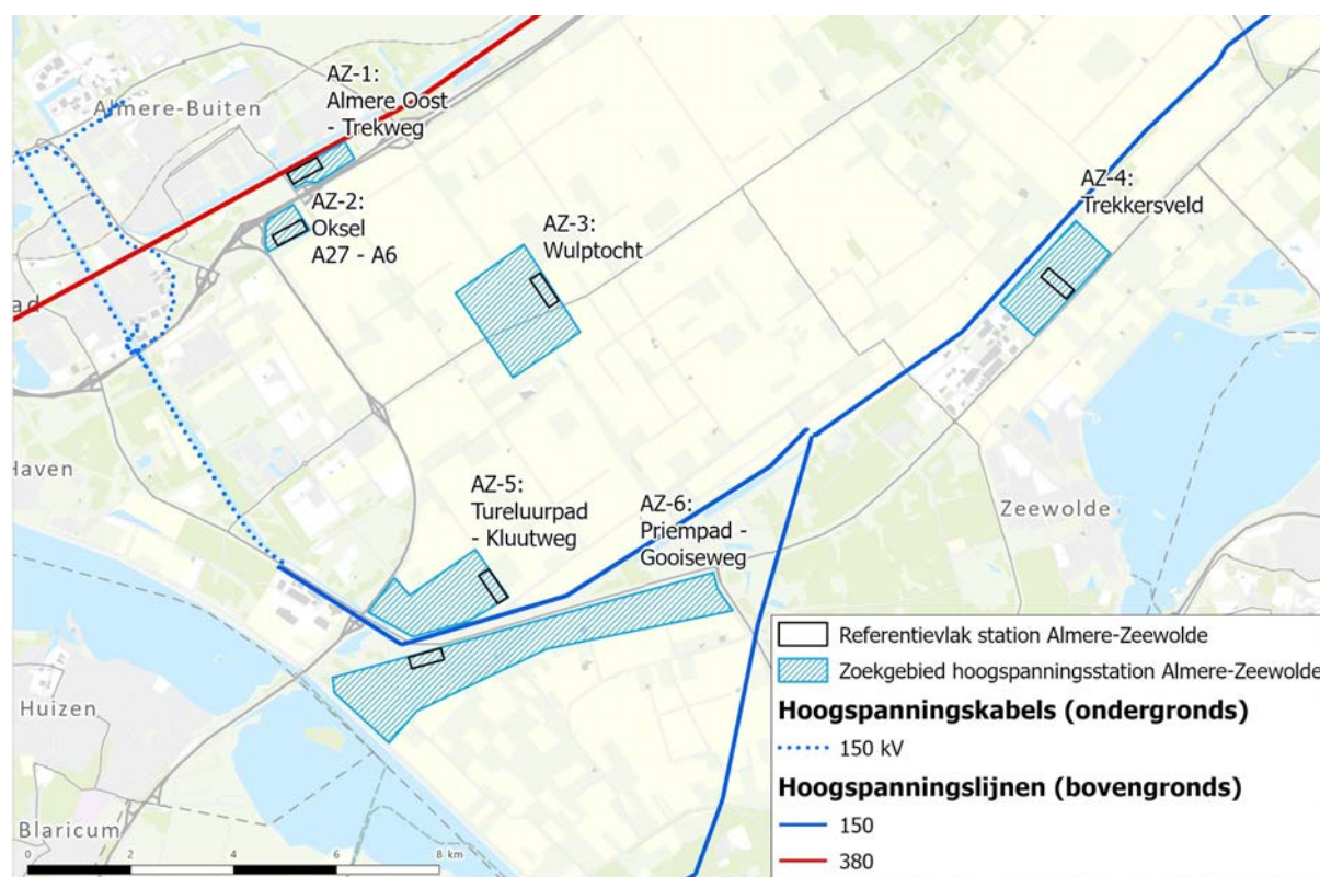
Figuur 3.7 Locatiealternatieven en referentievlakken nieuw 380 kV-hoogspanningsstation Almere-Zeewolde
