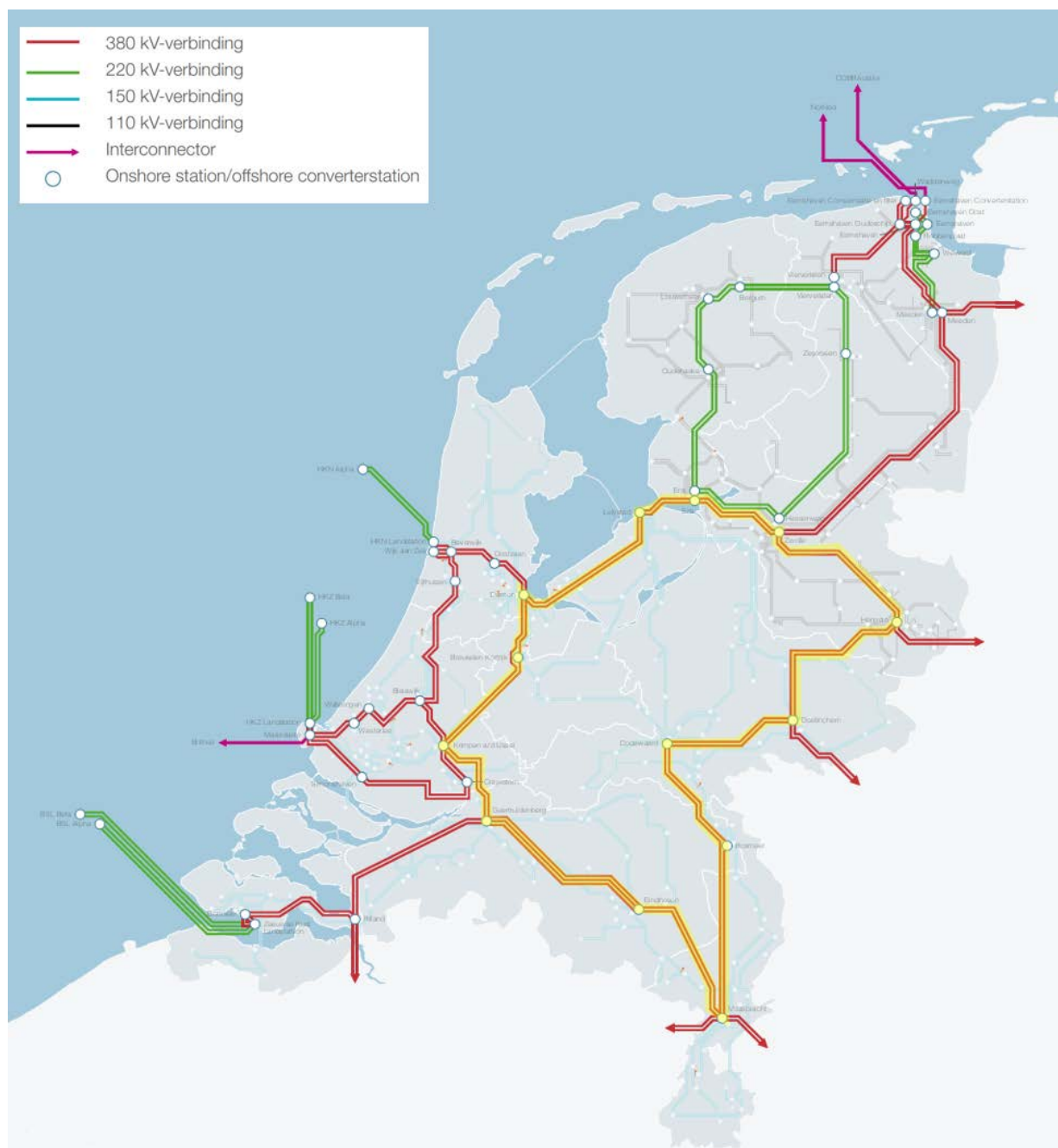
Figuur 1.1 Het Nederlandse hoogspanningsnet per 1-1-2024 (bron: Ontwerpinvesteringsplan Net op land 2024 - 2033, TenneT). Met de gele arcering is de 'hoofdringstructuur' weergegeven
