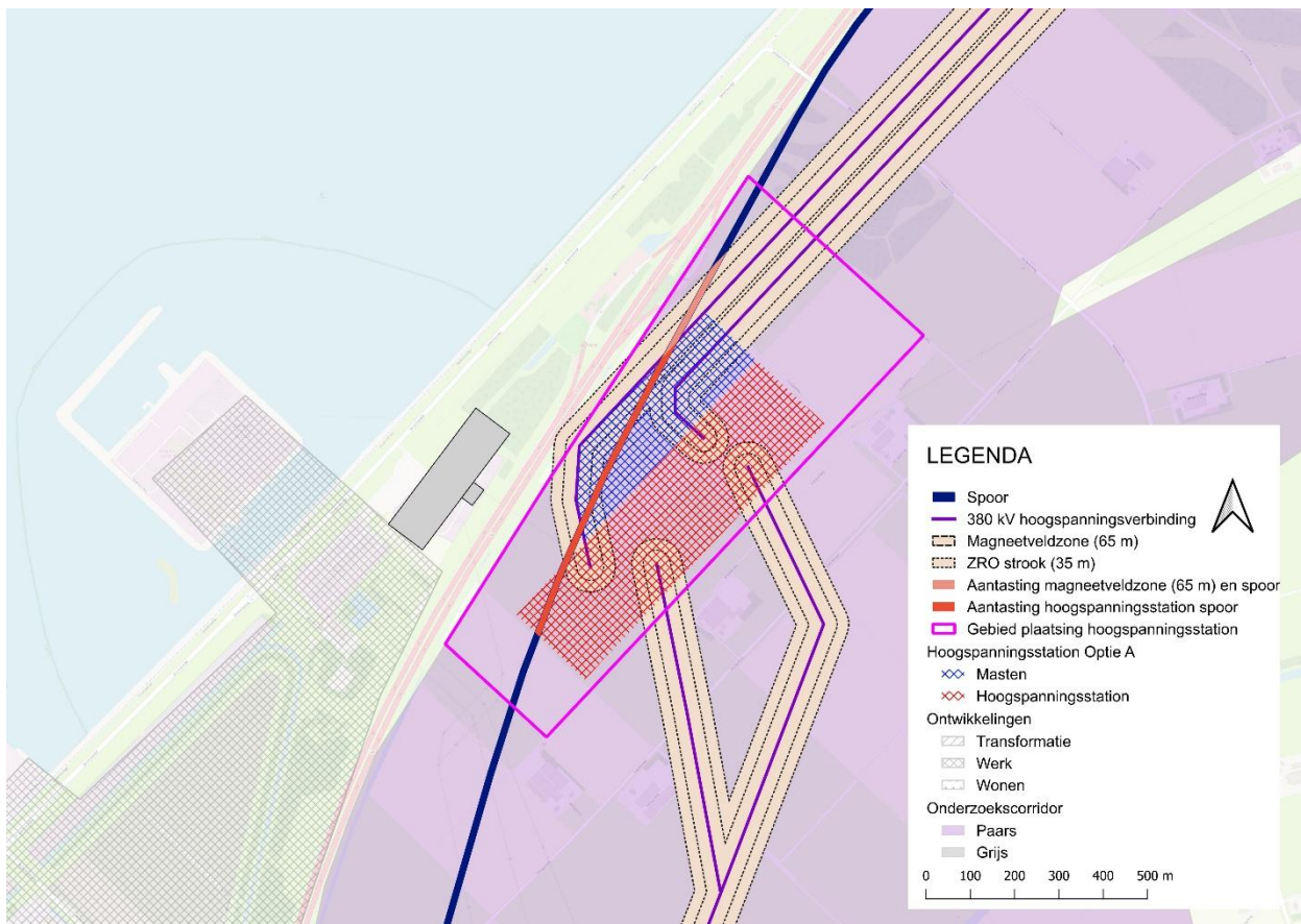
Figuur 4.3-1: initiële positie van het nieuwe hoogspanningsstation Lelystad in relatie tot de Lelylijn
