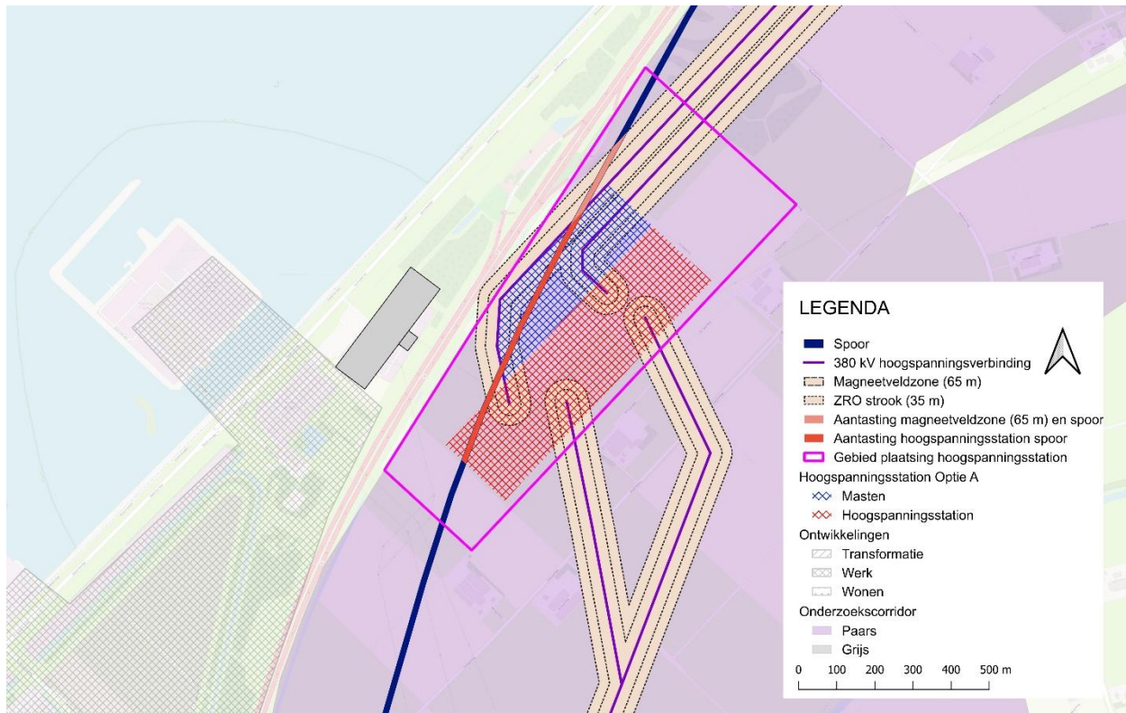
Figuur 2: Situatietekening beoogd nieuw hoogspanningsstation
