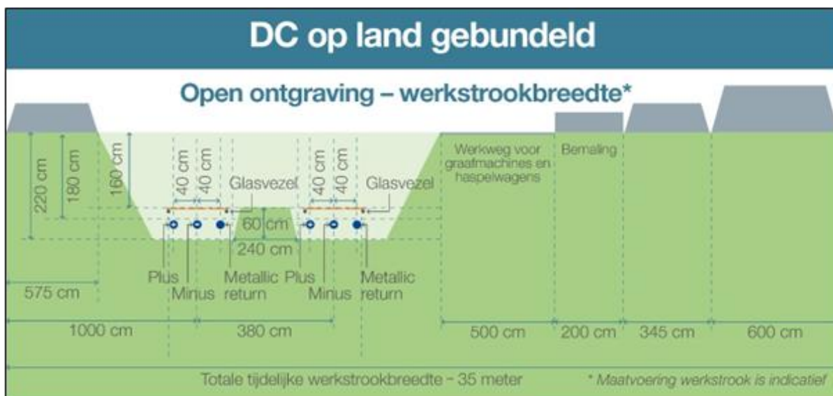
Figuur 2-5: Kabelconfiguratie DC-verbinding op land in open ontgraving van 2x 2 GW projecten, inclusief werkterrein en werkwegen (Bron: TenneT).
