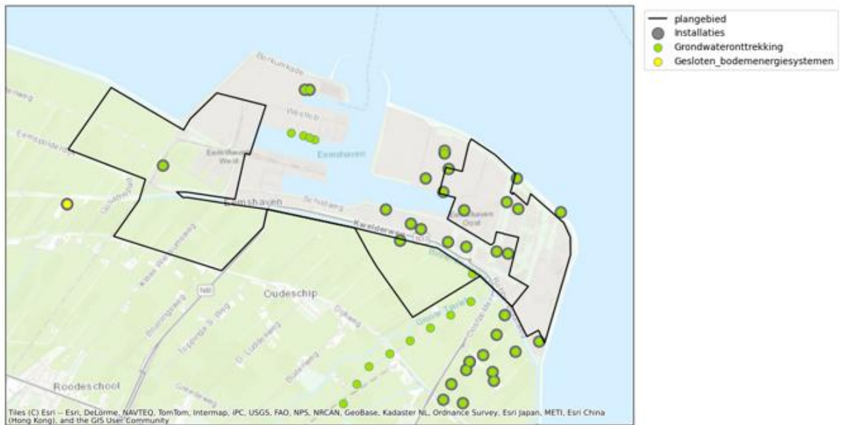
Figuur 6-12 Grondwateronttrekkingen in de nabije omgeving van het plangebied (zwarte lijn) (bron: WKO-tool)
