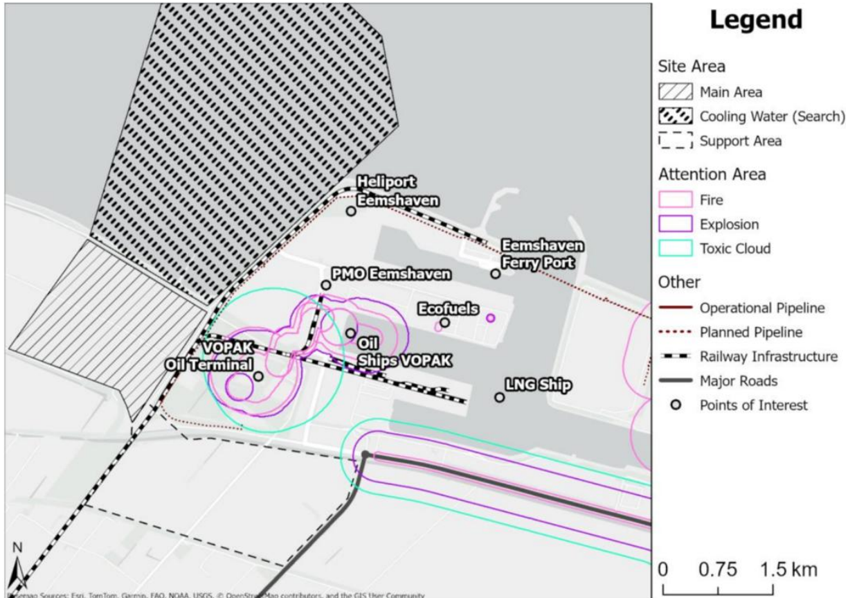
Figuur 5-12 Risicovolle activiteiten en de corresponderende aandachtsgebieden: brand-, explosie- en gifwolkaandachtsgebied. Bron: External Safety Report, Mott Macdonald, 2025.
