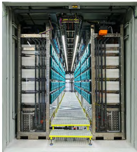
Foto: Modulair opgebouwde elektrolyser XINTC
