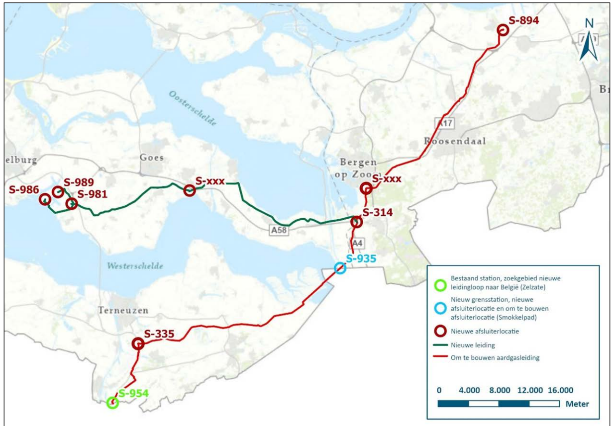
Figuur 2-3 Ligging van het tracé inclusief nieuwe afsluiterlocaties, grensstation Smokkelpad en leidingloop Zelzate als onderdeel van het Waterstofnetwerk Zuidwest-Nederland.
