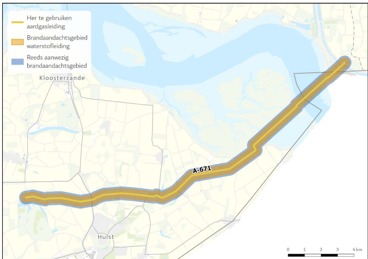
Figuur 11-3. Het brandaandachtsgebied van deel 2 van de hergebruikte leiding A-671 met waterstof en met aardgas (Bron: QRA Arcadis Nederland).
