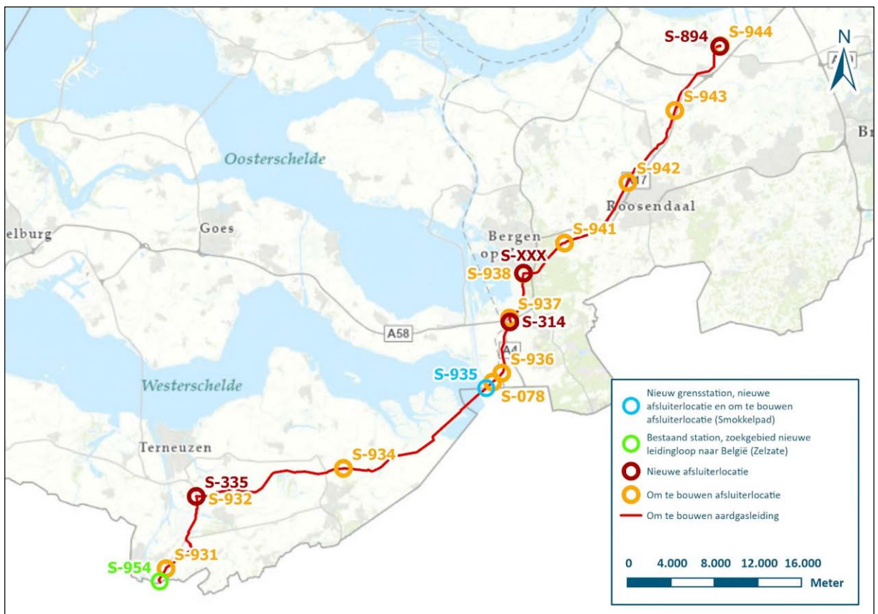
Figuur 3-6. Ligging van de om te bouwen bestaande aardgasleiding Zelzate – Moerdijk als onderdeel van het Waterstofnetwerk Zuidwest-Nederland.
