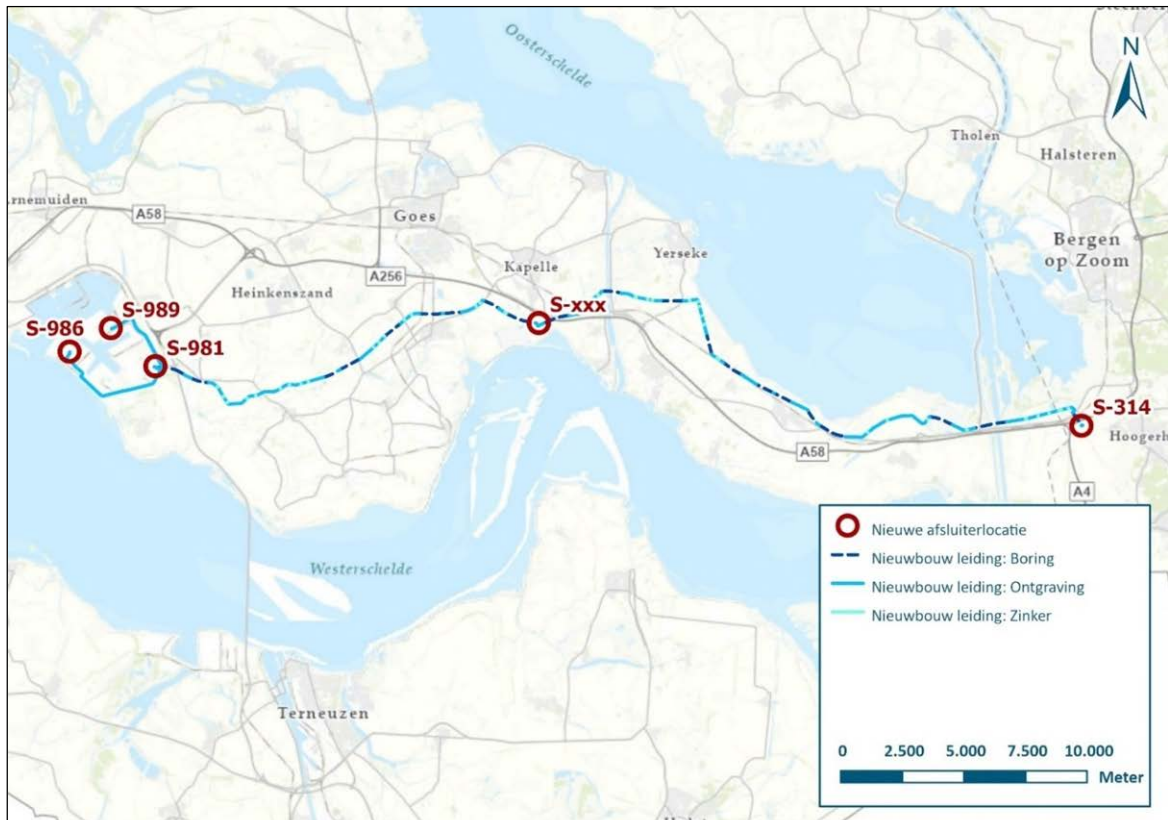
Figuur 3-7. Voorgenomen ligging van het nieuw te realiseren tracé als onderdeel van het Waterstofnetwerk Zuidwest-Nederland.
