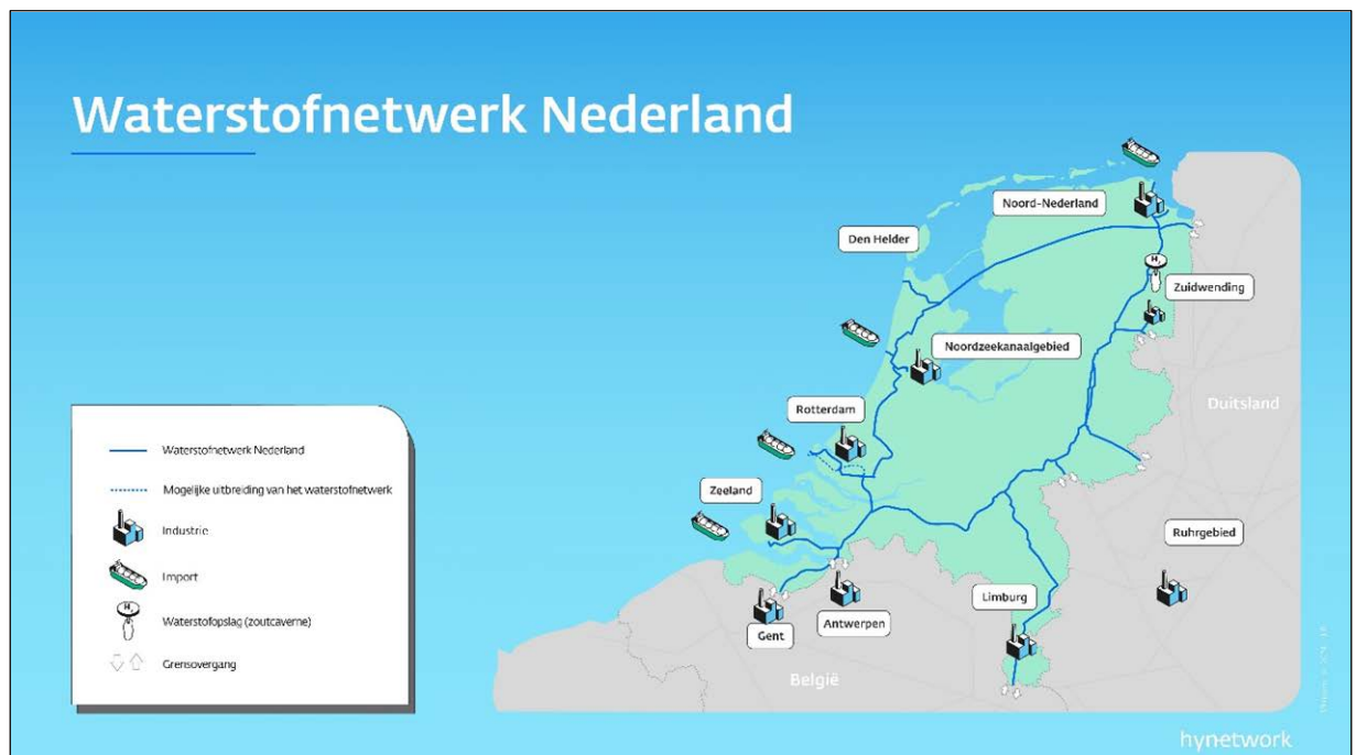
Figuur 2-1. Schematisch overzicht van 'Waterstofnetwerk Nederland' met verbindingen naar Duitsland en België (conceptvoorstel aanpassing uitrolplan) (bron: Hynetwork).
