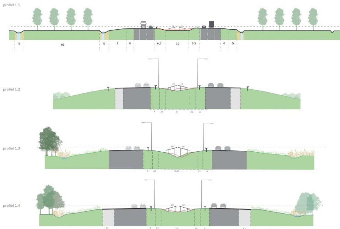
Afbeelding 5.7 Dwarsprofielen middenbermen [ref. 12]
