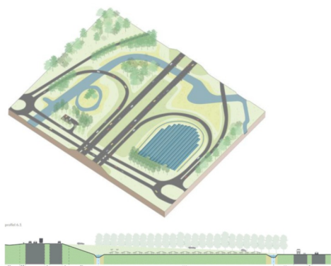
Figuur 2.10 Zonnevelden in oostelijke knoop bij aansluiting 11
