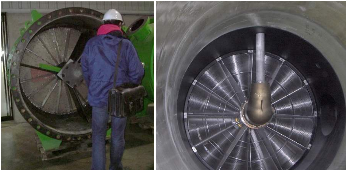
Figuur 5. Zelfreinigende debrisfilters ('mosselzeven') die als een flens in een koelwaterleiding wordt ingebouwd (foto credit: links H.A. Jenner; rechts M. Holierhoek).
