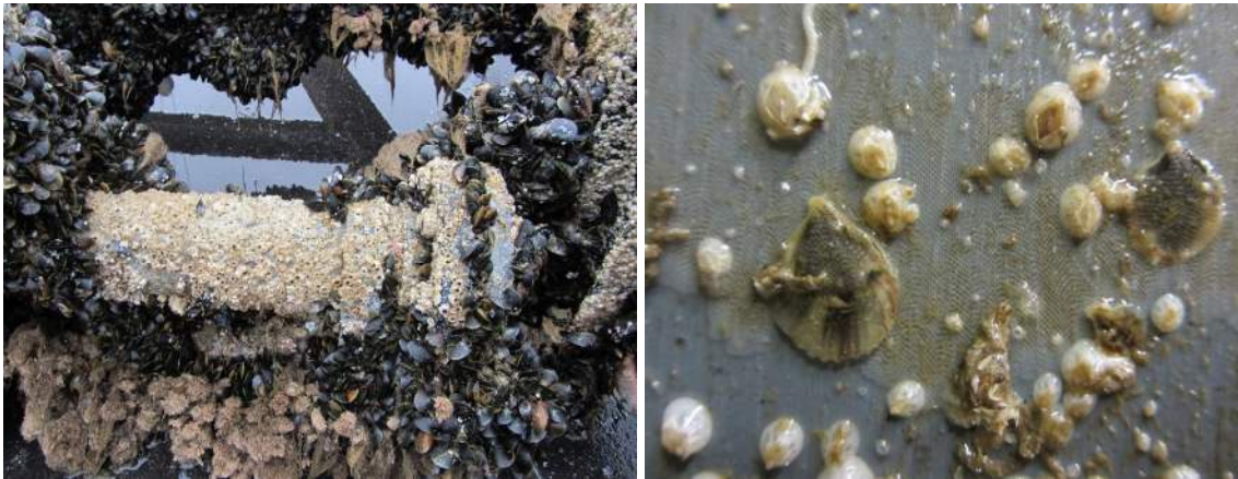
Figuur 1. Soortenrijkdom biologische aangroei: links op equipment in een koelwaterinlaat (links) en rechts pokken, kalkkokerworm oesters en bryozoa op een monitoringsplaat (rechts) (foto credits: Pecten Aquatic).
