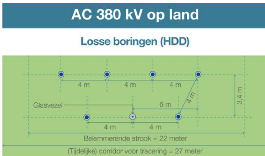
Figuur 2-8: Kabelconfiguratie AC boring op land voor 1 AC verbinding bestaande uit twee circuits (Bron: TenneT).
