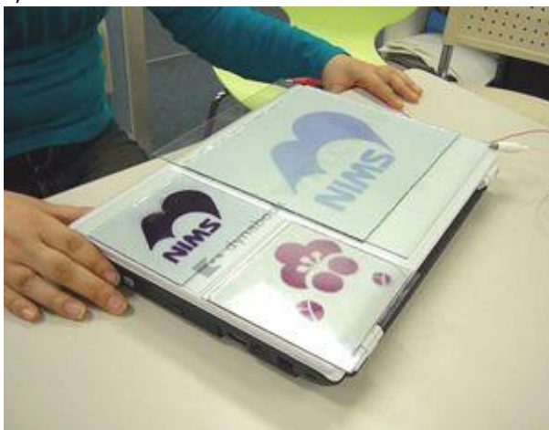
Fig. 2. Higuchi's elektronische papier in kleur (bron: MANA persbericht ).
