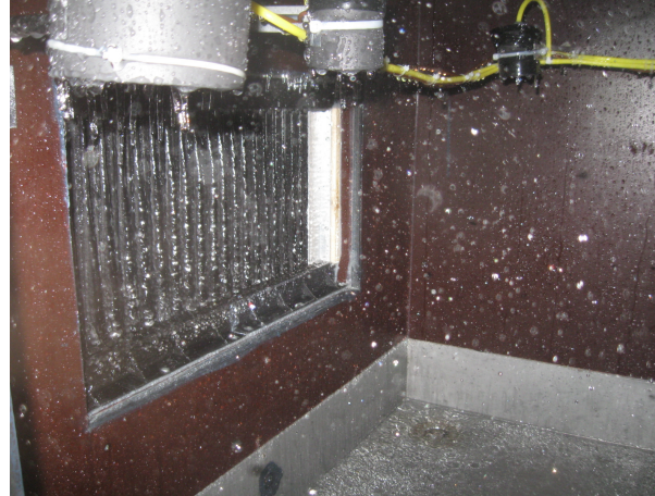
Figuur 17.19 - Meetsessie 44b \theta_e = -6^{\circ}\text{C} – 1 sproeier - R_{WL} = 0,22
