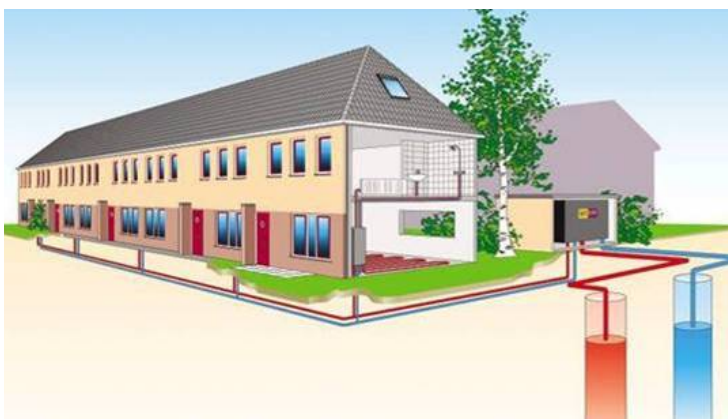
Figuur 8.3: Warmtepomp met warmte en koudeopslag op wijkniveau [34].
