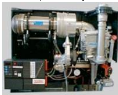
Figuur 6.10: Inwendige van een Stirling \mu -WK systeem.
