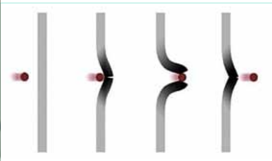
Projectiel door een ionomere wand / Bullet through an ionomeric wall
