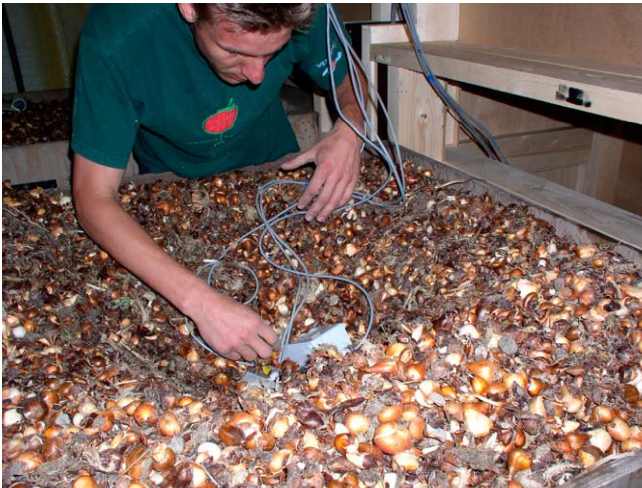
Ingraven van sensoren voor onderzoek naar energiebesparing bij drogen en bewaren
