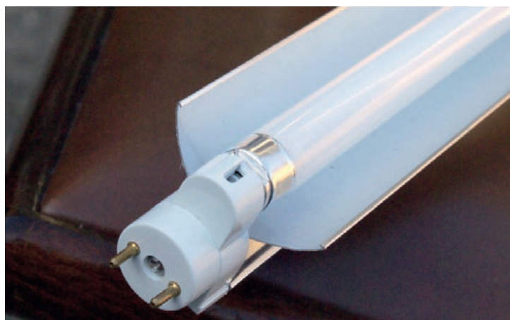
Adapterset voor de T5-lamp, bestaande uit een overbrugger en twee opzetstukken met ingebouwd elektronisch voorschakelapparaat. Deze buis kan zo in de bestaande tl-armatuur (op de foto links) geplaatst worden.
