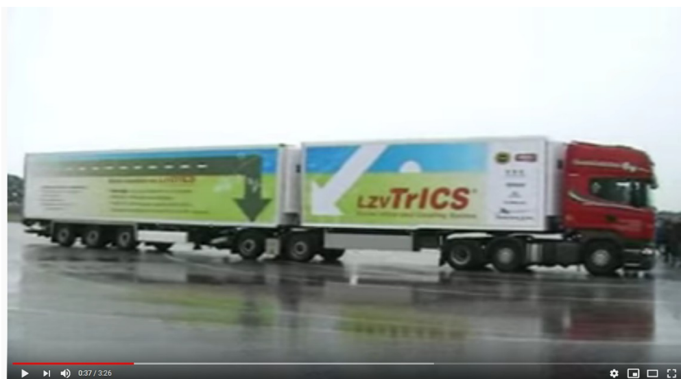
Afbeelding 1: LZV-voertuig bestaande uit een trekker, een hoofdtrailer en een volgtrailer.
