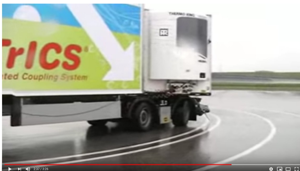
Afbeelding 3: de hoofdtrailer is voorzien van meesturende achterste twee wielassen.
