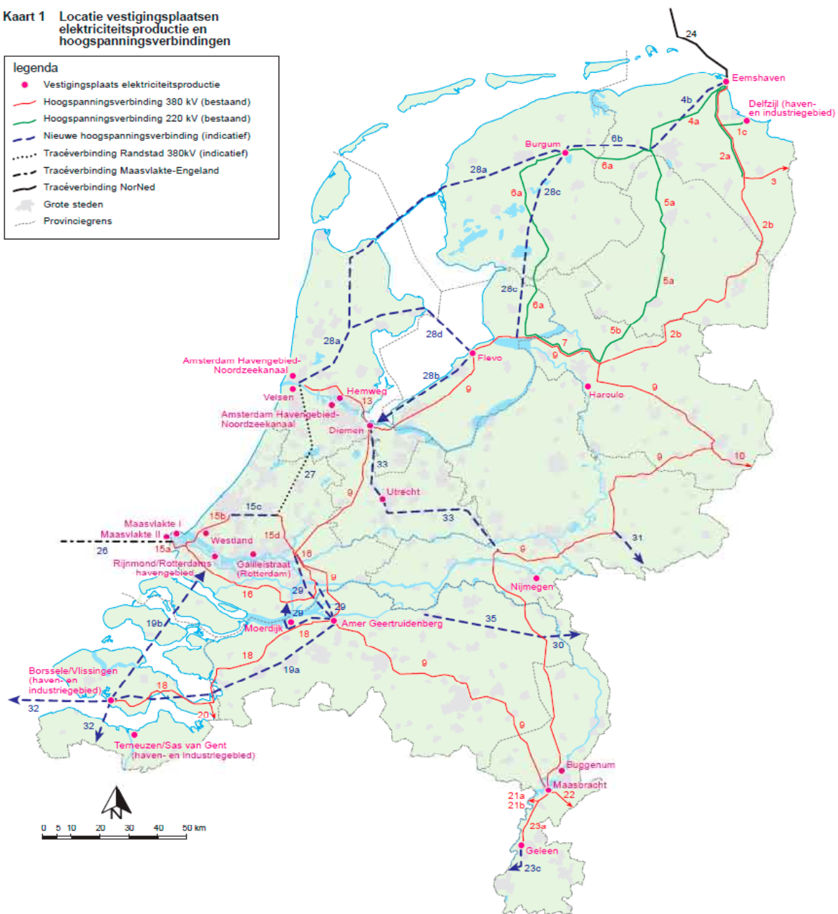
Abbildung 2.1 Standorte der Elektrizitätsproduktion und Hochspannungsleitungen (SEV III)
